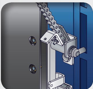
DISPOSITIVO PER ARRESTO CARRELLO IN CASO DI CADUTA ACCIDENTALE. SPOOL CARRIAGE STOPPING DEVICE IN CASE OF ACCIDENTAL FALLING.
